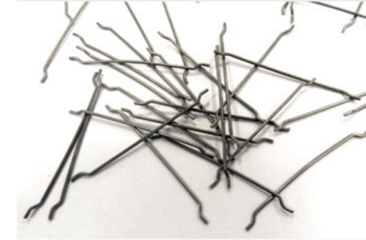
Las fibras de acero son elementos de reducida dimensión, producidas a partir de alambres de acero y conformadas en frío. El uso de Fibracero® reduce y controla la retracción del hormigón, actuando como una armadura tridimensional, disminuyendo su tendencia a la fisuración del fraguado.
