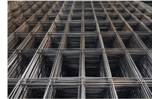
Estas mallas son estructuras planas formadas por alambres de acero dispuestos en forma ortogonal y electrosoldados en todos los puntos de encuentro, se fabrican según el diseño exacto que requiera el proyecto. Son producidas bajo la norma IRAM-IAS U500-06, designación AM 500. El alambre utilizado Acindar T-500®, es laminado y conformado en frío. Posee una tensión de fluencia característica de 500 MPa, conforme con la norma IRAM-IAS U500-26, designación ATR 500.
