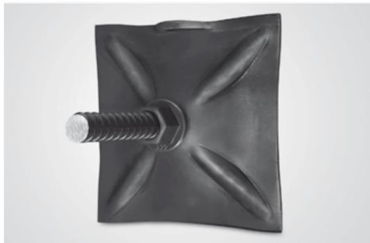
El kit para sistemas de fortificación se compone de un perno roscado de alta resistencia laminado en caliente, una placa de sujeción de acero estructural y una tuerca, que se desplaza sobre el perno para permitir el posicionamiento de la placa sobre el macizo rocoso.
